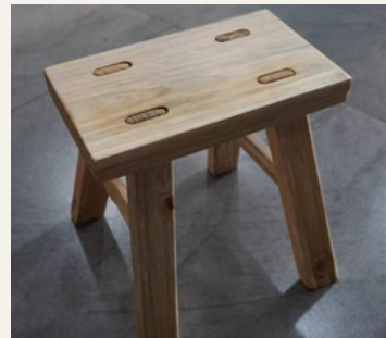
2. 將凳腳置於椅凳背面， 依正確方向使用木槌敲擊組裝
